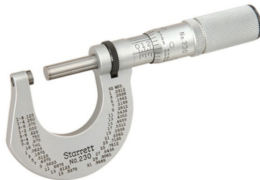
Figura 3: Micrómetro usado para medir espesores pequeños.
